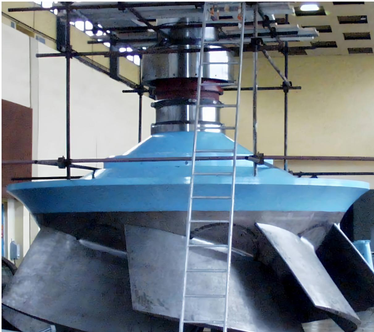
*Рис. 10 Диагональная турбина*
