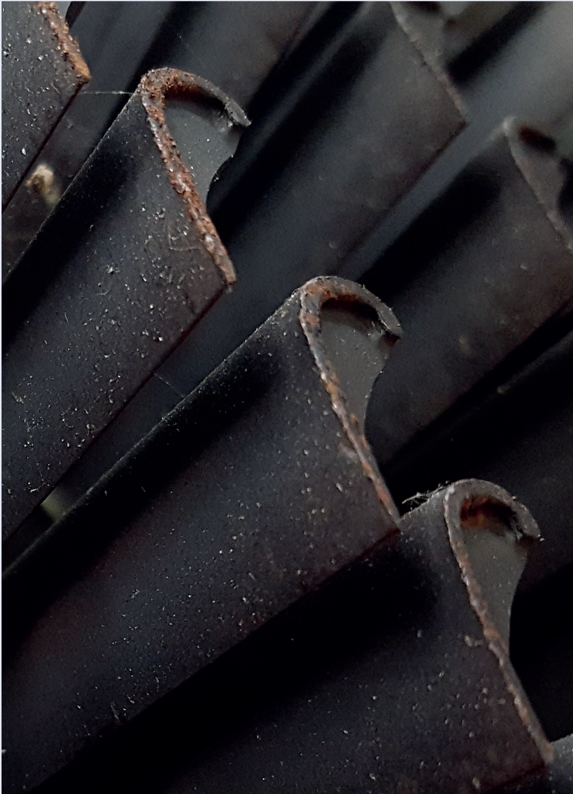
Коррозия лопаток, shutterstock.com
