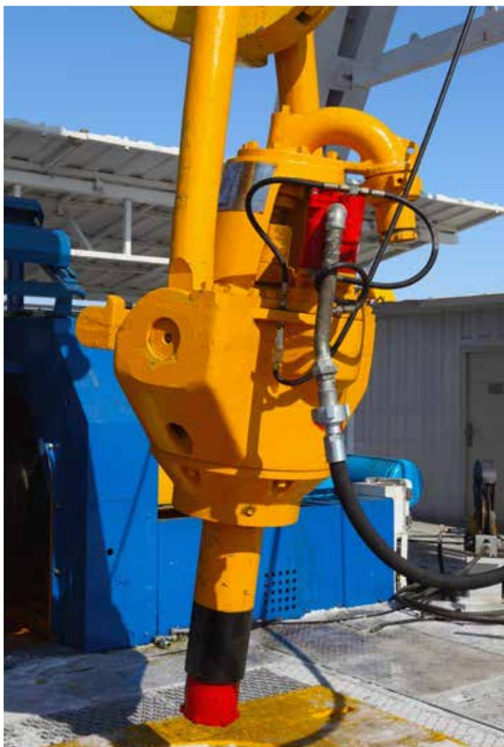
**Вертлюг** — Вертлюг предназначен для подвода бурового раствора во вращающуюся бурильную колонну. В процессе бурения вертлюг подвешивается к автоматическому элеватору либо к крюку талевого механизма и посредством гибкого шланга соединяется со стояком напорного трубопровода буровых насосов.
