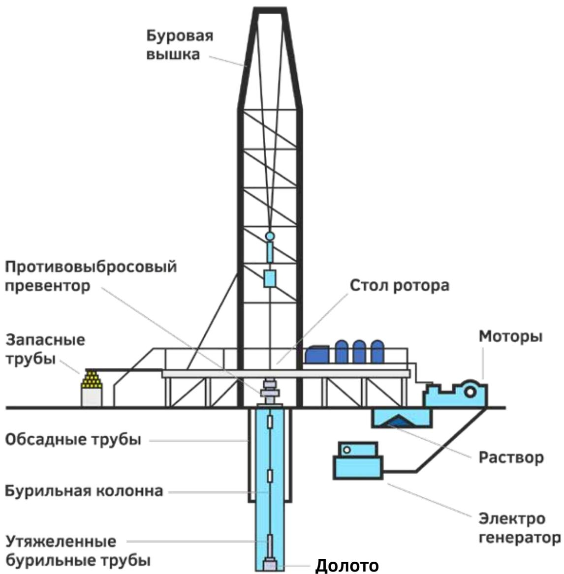
Рис. 1 – схема буровой установки
